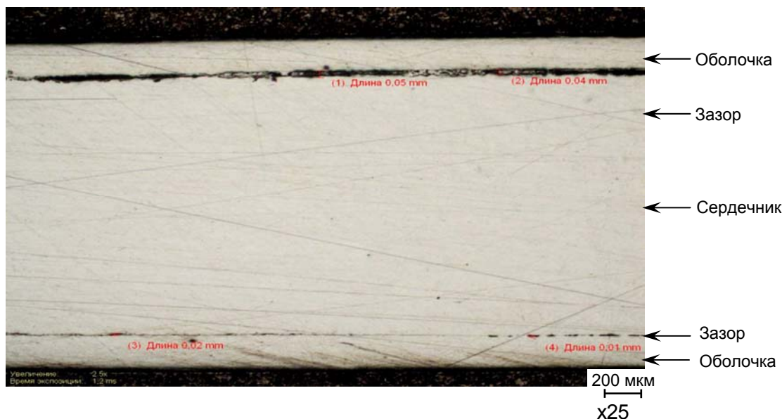
Рис. 3.19. Изображение зоны контакта оболочки и сердечника, созданного за счёт разряжения внутри изделия, с указанием длины образовавшихся зазоров в зоне контакта
