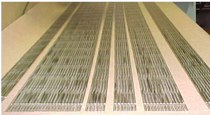
Рис. 3.32. Внешний вид твэлов (а) для гибридной активной зоны реактора БН-800 и их маркировка (б)
