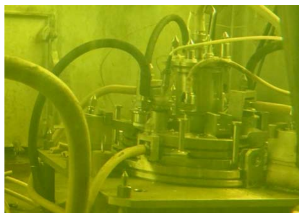
Рис. 3.29. Внешний вид лабораторного экспериментального образца опытно-промышленного аппарата сорбционной очистки соли от продуктов деления
