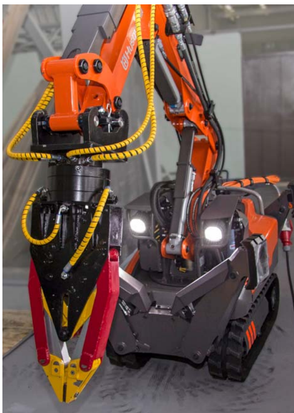
Рис. 3.11. Внешний вид электрогидравлической машины для проведения работ в радиационно-защитной камере без присутствия человека
