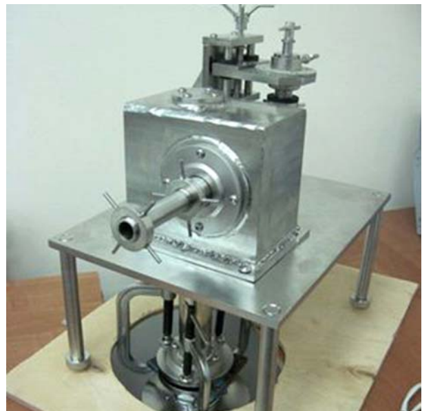
Рис. 3.16. Внешний вид установок для термодеструкции (а) и сварки мишеней (б) участка изготовления мишеней-накопителей трансплутониевых элементов
