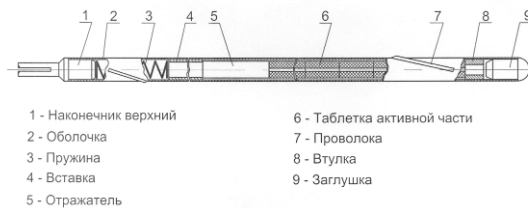
Рис. 10 Топливный стержень реактора ИБР-2М
